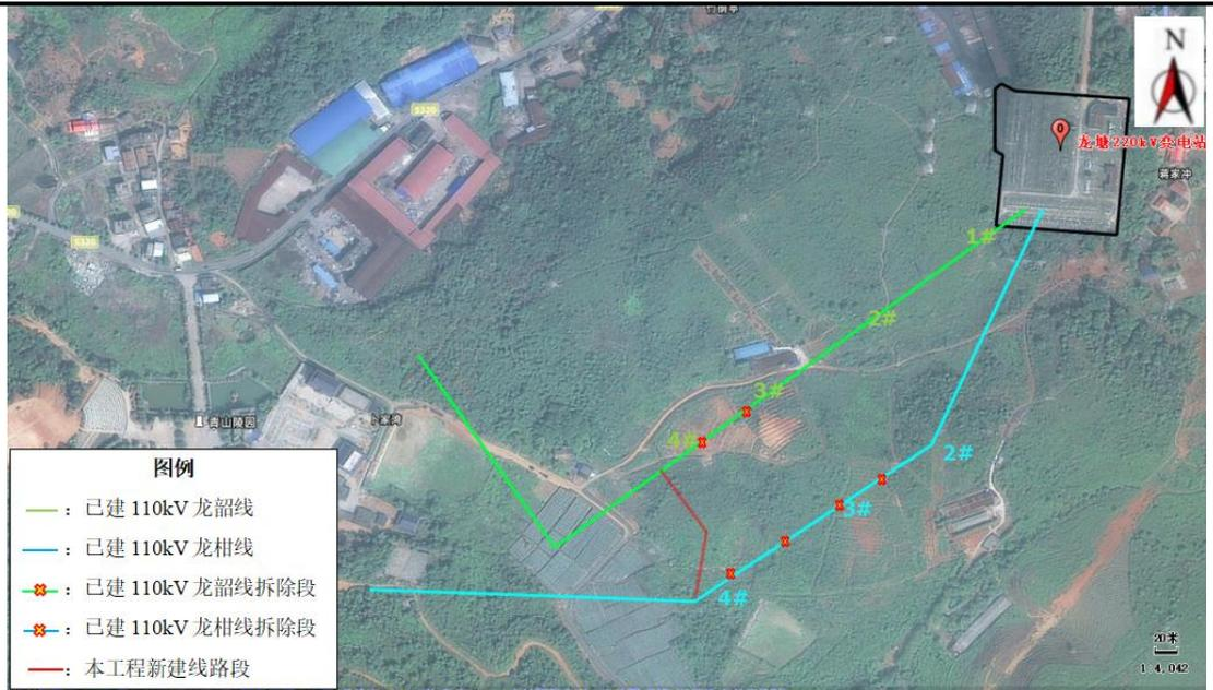
图 2-10 新市—韶能耒杨电厂—龙塘、龙塘—柑梨冲 B 线 110kV 线路对接工程路径走向图
