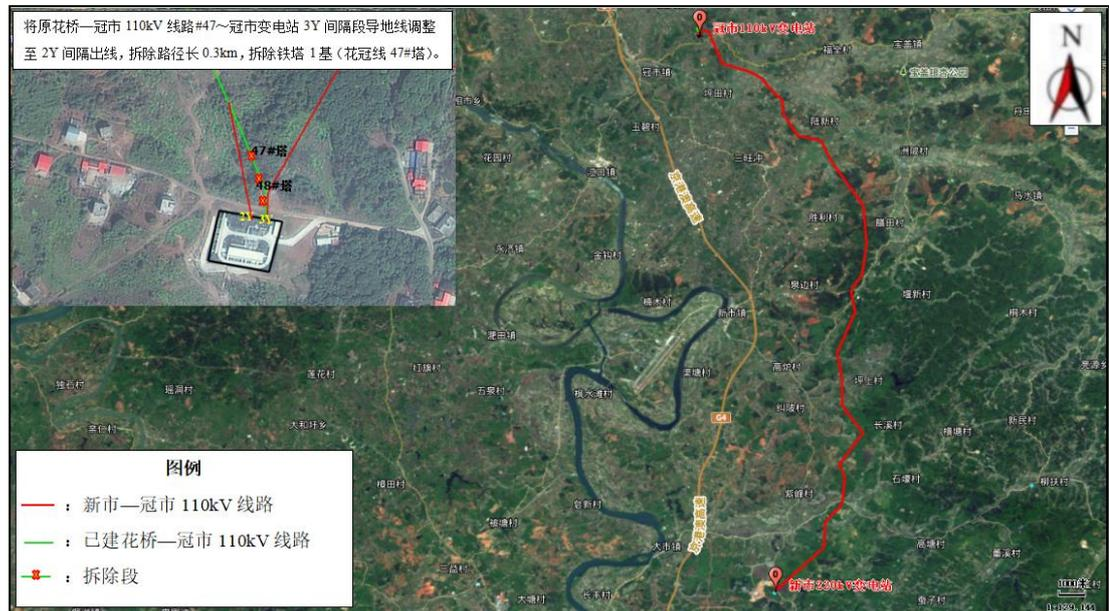
图 2-4 新市—冠市 110kV 线路工程线路路径走向图
