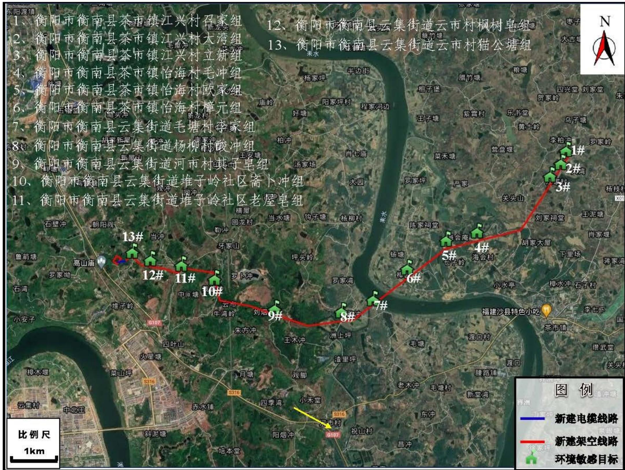
附图 3: 湖南衡阳衡南县黄吉 50MW 林光互补光伏项目 110kV 送出工程与环境敏感目标位置关系图
