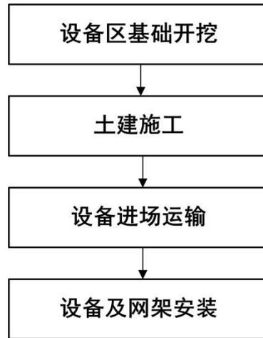
图1 变电站扩建间隔工程施工工艺流程
