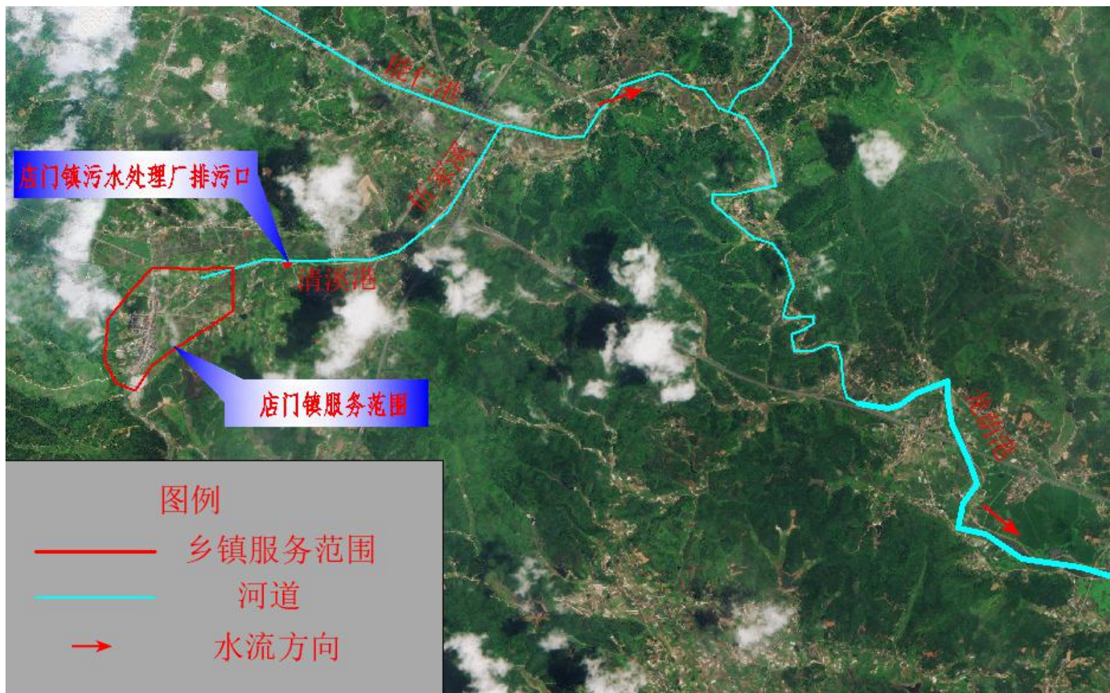
图 5.4.1 店门镇污水处理厂污水入河路径示意图
