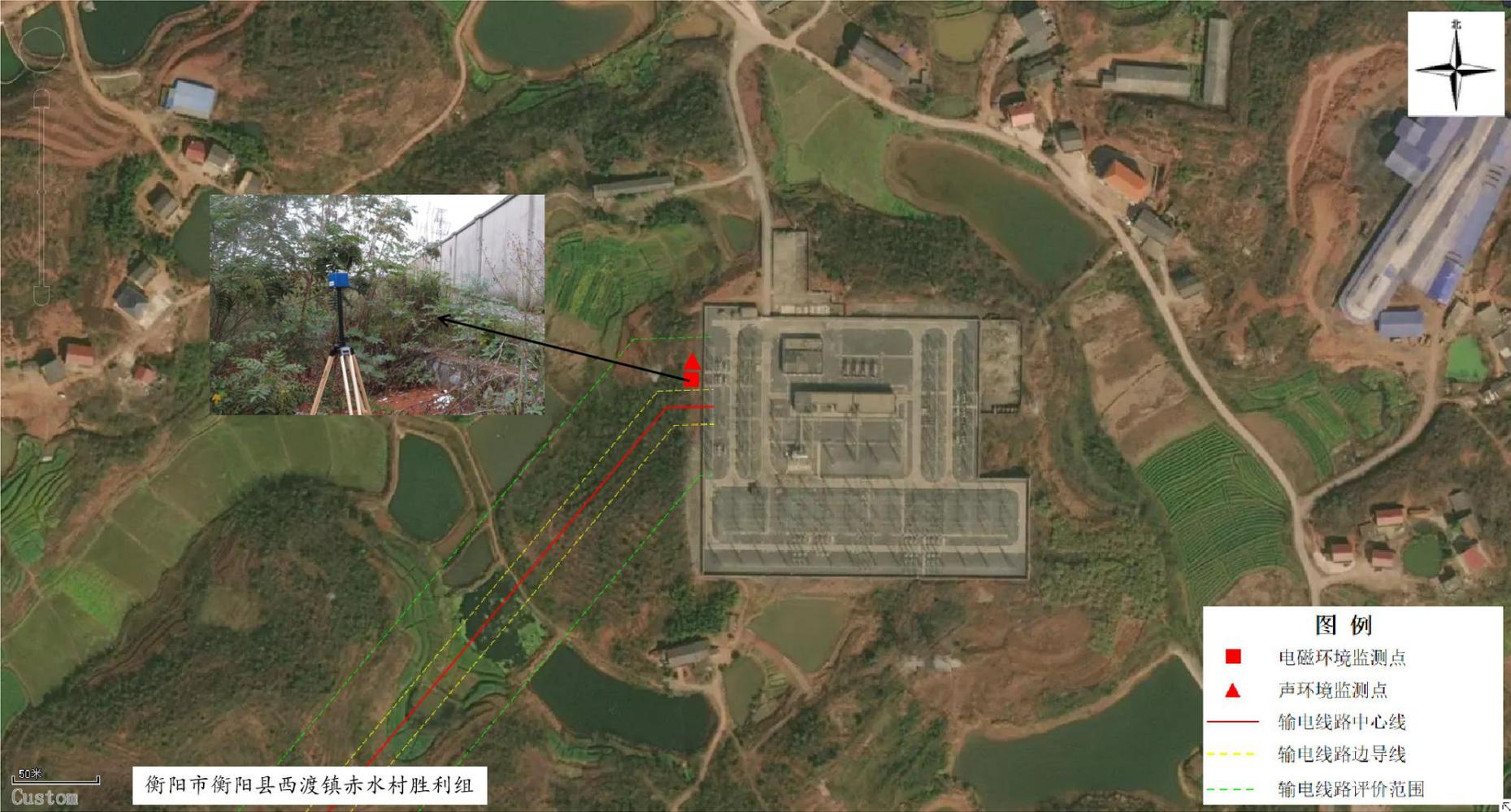
附图 4：湖南衡阳衡南泉湖 110kV 变电站厂界监测布点图
