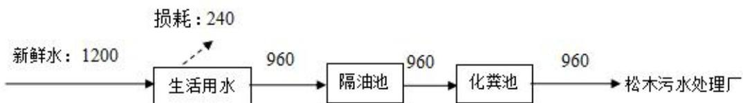
图 2-3 扩建后全厂项目运营期水平衡图 单位：m³/a
