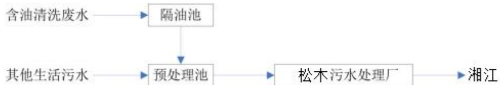
图 4.1-1 项目生活污水处理流程图
