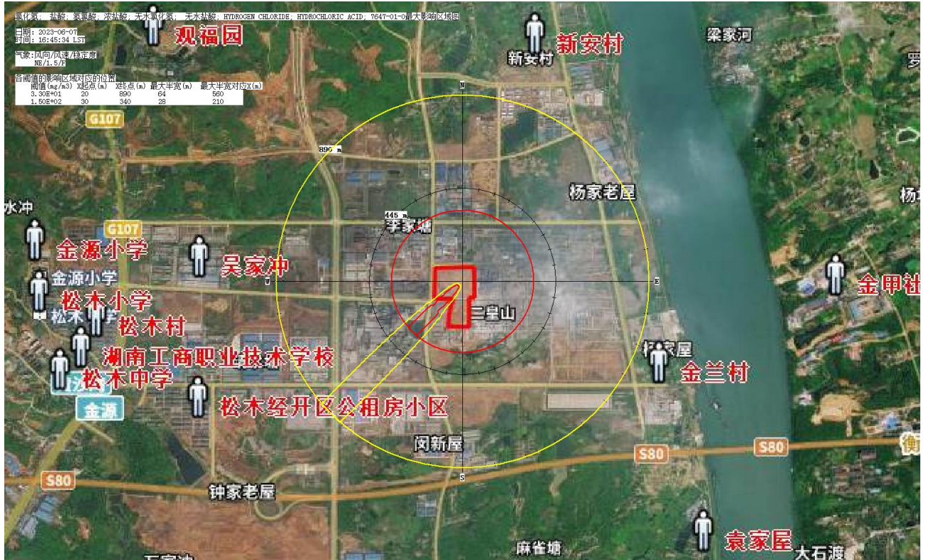
图 7.3-2a 最不利气象条件氯化氢预测浓度达到不同毒性终点浓度的最大影响范围示意图
